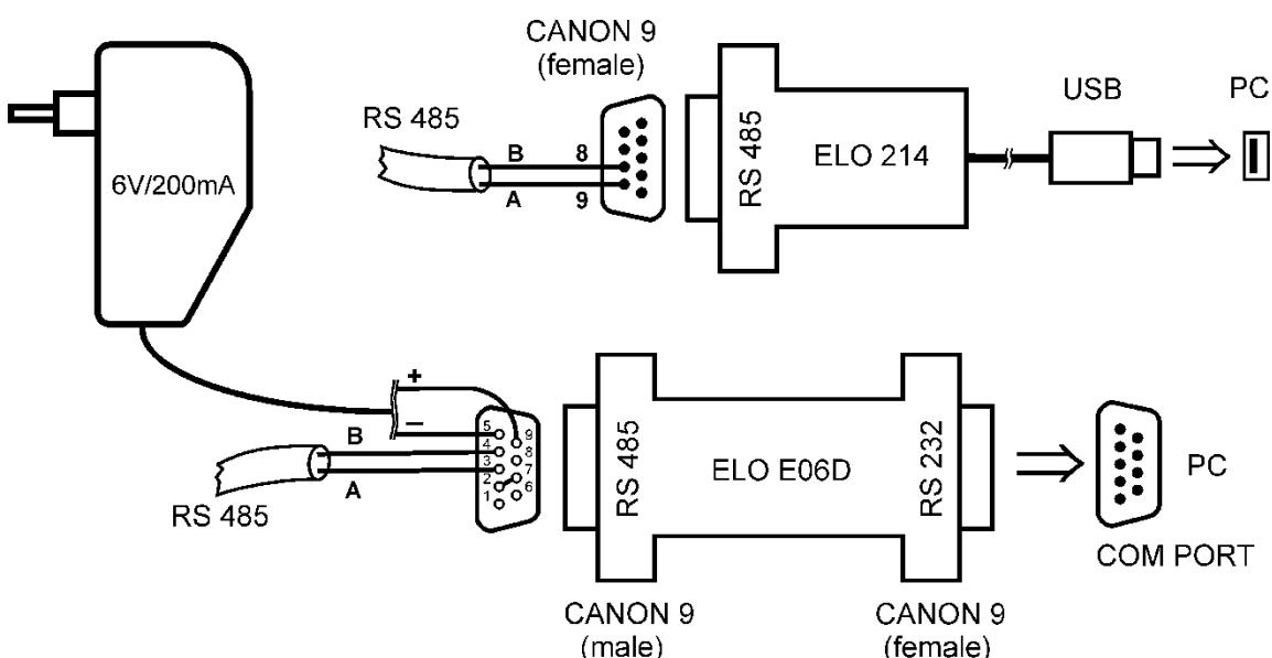
Pro připojení regulátoru s rozhraním RS485 k PC přes sériový port RS232 je jako volitelné příslušenství nabízen převodník ELO E06D. Konektorem označeným RS232 se připojí přímo do PC, na konektoru označeném RS485 se na vývod č.9 připojí napájecí napětí +6V DC z externího adaptéru, na vývod č.5 se připojí 0V. Dále se mezi sebou propojí vývod č.2 a vývod č.7. Sběrnice RS485 se připojí na vývody č.3 (A+) a č.4 (B-).
